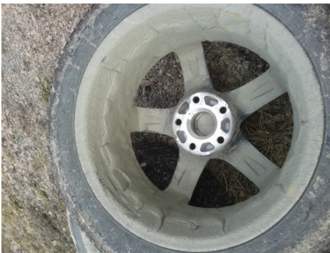
Svartsjövägens beläggning sitter som cement i däck
